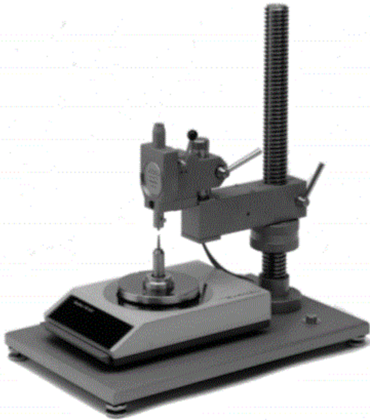
图 3 用于检验邵氏硬度计弹簧力的天平
