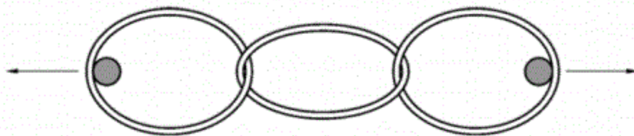
图 E.1 三环链拉伸试验示意图
